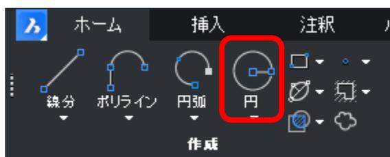
19. 作図カーソルをフィレットの中心点のそばに持っていくと「中心」を認識します。円の中心点としてフィレットの「中心」を選択します。
