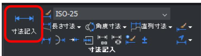
30. 寸法の基準とする2点を選択し、寸法を配置位置を選択します。
