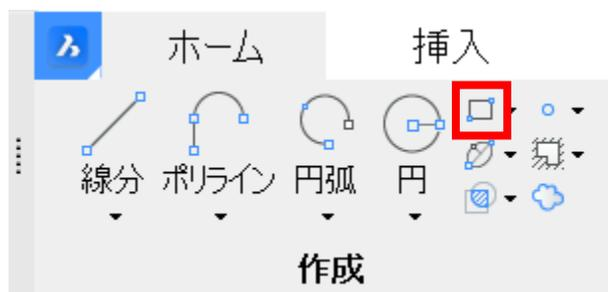
画面の任意の場所でクリックし、カーソルを動かしたらキーボードで「200 Tab 800」と入力し、Enterキーで確定します。
